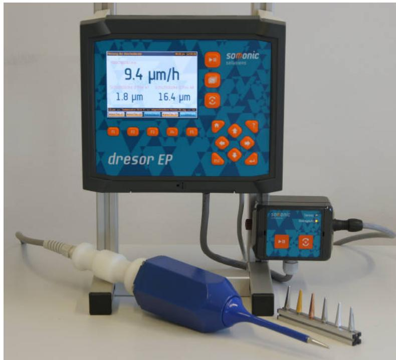
**Messgerät *dresor EP* Basisgerät mit Anschlussbox, Stabsensor, Messprobekörper**
